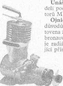
**Chladicí plášt** z duralu je nasunut na vložku válce a spolu s hlavou svírá přírubu vložky. Celá tato skupina je přitažena třemi šrouby M 2,6 × 24 ke klikové skříni, která je zakončena těsně nad výfukovým potrubím dosedací plochou pro chladicí plášt.
